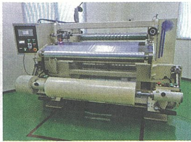
近く本稼働を始めるリワインドスリッター
